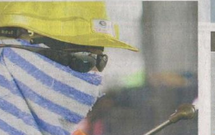
MEMAKAI topi khas, cermin mata gelap dan menutup muka menjadi aspek keselamatan yang penting bagi seorang jurukimpal di Jurunature.
